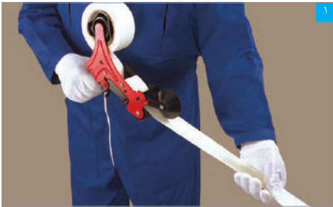
خم کردن نوار درزگیر با دستگاه تازن
